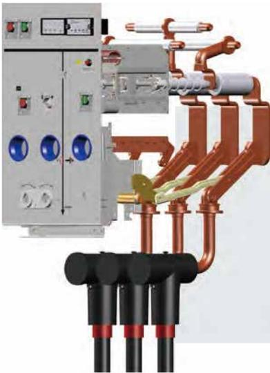
所有带开关柜型均配备三工位刀闸，三工位刀闸与主开关一同内置于封闭的环氧腔体内。它配备三相主轴，可操作实现母线/隔离/接地三个位置。由于三工位刀闸采用了机械联锁，只有在主开关处于断开位置时，三工位刀闸才能打开操作孔进行操作。
