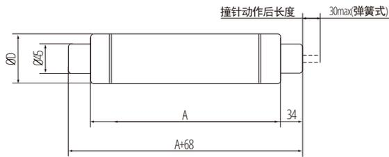
熔断器撞击器：中型（符合GB15166.2《交流高压熔断器限流式熔断器》要求）
